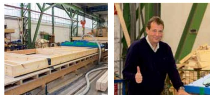
„Wir haben früher mit einer Düse eingebblasen. Durch die Einblasplatte wurde der Produktionsablauf vereinfacht und wesentlich verkürzt. Vor allem das Bohren und Verschließen der Löcher bringt ordentliche Zeiterparnis. Auch Innenwände mit 8 - 12 cm sind kein Problem für die Isoblow Elements Einblasplatte. Heute dämmen wir zu 100 % mit Zellulose.“
